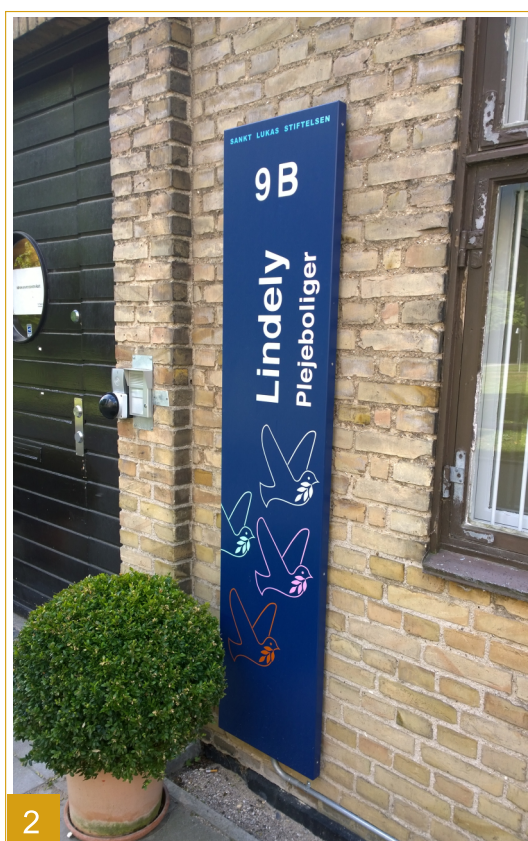
2 Alubakke 500 x 2200mm., ombukket 25mm 4 sider, RAL-lakeret. Denne alubakke er vist med fræs og LED-lys.
